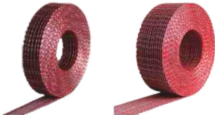
I-50 – Odcinek stalowy 4,81 mm 2 - Wytrzymałość stali 2200 N/mm 2 I-100 – Odcinek stalowy 9,62 mm 2 - Wytrzymałość stali 2200N/mm 2
